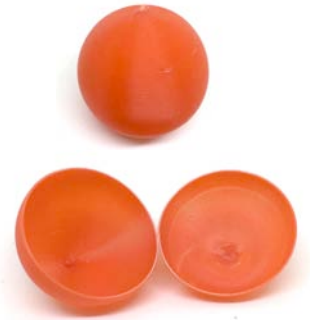
図 2 螺旋 3D 印刷した球
